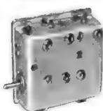
**UHF-Converter-Tuner** zum Einbau in FS-Geräte der deutschen, französischen und US-Norm. Er dient zum Empfang von UHF-Sendern im Bereich von 470–860 MHz. Die Abstimmung erfolgt kapazitiv und nahezu frequenzlinear. Unter-setzer Antrieb 1:6,5. Antenneneingang: 240 Ω. Antennenausgang: 240 Ω (Kanal 3 oder 4, 54–68 MHz) 36.—
