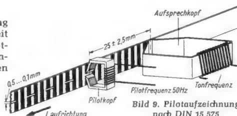
Bild 9. Pilotaufzeichnung nach DIN 15 575
