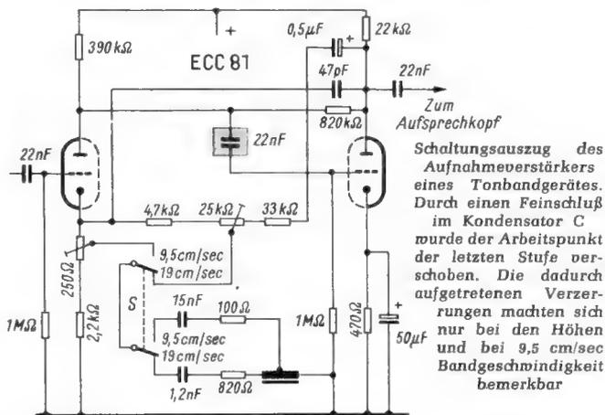
Schaltungsauszug des Aufnahmeverstärkers eines Tonbandgerätes. Durch einen Feinschluß im Kondensator C wurde der Arbeitspunkt der letzten Stufe verschoben. Die dadurch aufgetretenen Verzerrungen machten sich nur bei den Höhen und bei 9,5 cm/sec Bandgeschwindigkeit bemerkbar
