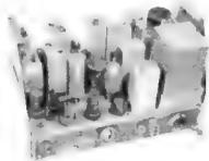
4. **US-30-W-FM-Sender, 27—45 MHz**, mit 6-V-Umformer u. 6 Röhren, ohne Quarze.
