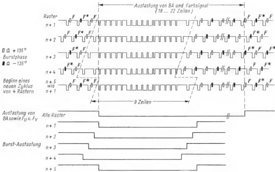
Bild 6. Austastungschema für die Farbsynchronimpulse während der Vertikalimpulse
