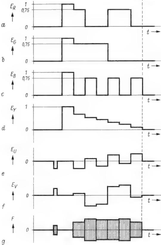
Links: Bild 3. Spannungen für ein Farbstreifentestbild nach EBU-Norm mit 100% Spitzenweiß und Farbfächen mit 75% Amplitude
