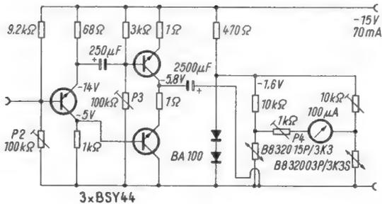
Links: Bild 3. Gegentakt-Endstufe und Anzeigeteil. Als Stromversorgung wird zweckmäßig ein stabilisierter Netzteil vorgesehen
