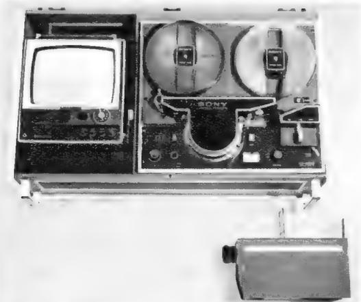
Videoaufzeichnungsanlage CV 2000 von Sony. Der Fernsehempfänger ist im linken Fach so angeordnet, daß er zum Betrieb leicht hochgeklappt und auch als Zweitempfänger einfach herausgenommen werden kann. Für die Vidikonkamera wird eine minimale Beleuchtung von 100 Lux angegeben. Die Anlage arbeitet nach der 525-Zeilen-Norm
