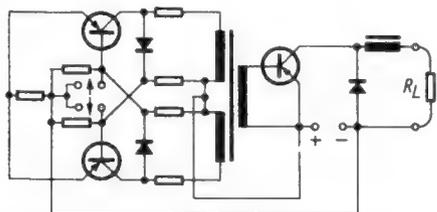
Bild 2. Prinzip eines einfachen Schaltverstärkers mit Transistoren; nach [1]
