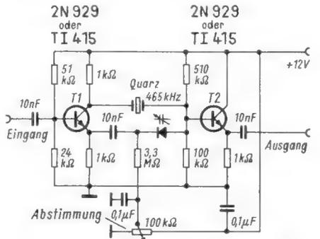
Bild 2. Schaltung eines abstimmbaren Kristallfilters ohne Transformator, die für Frequenzen zwischen 100 kHz und 1,6 MHz geeignet ist
