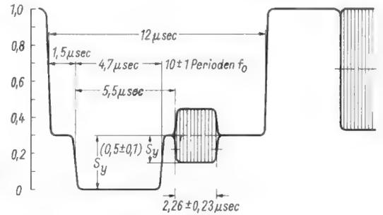
und nach Addition der Synchronisierimpulse  $S_y$  wird es zu einem BAS-Signal, das das übliche BAS-Signal des Schwarzweißkanals ersetzt.
