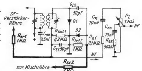
Rechts: Bild 30.6. Erzeugung der Mischröhren-Regelspannung durch besondere Regelspannungsdiode, Zf-Stufe durch Demodulatorrichtspannung schwächer geregelt
