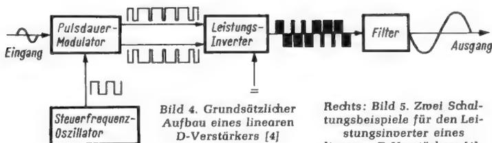
Bild 4. Grundsätzlicher Aufbau eines linearen D-Verstärkers [4]
