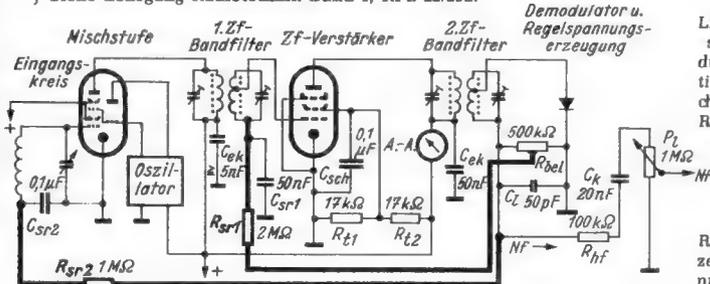
Links: Bild 30.5. Regelspannungs-Erzeugung durch die Demodulationsdiode (mit schwächerer Regelung der Zf-Röhre als der Mischröhre)
