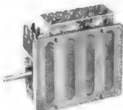
**ET 21 Trans.-Tuner - ETC 22 Converter-Tuner 2 x AF 139**, mit Eing.-Baluntrafo, Ausg.-Symm.-Glieder und Schaltung
