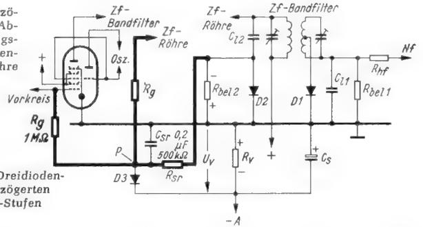
Rechts: Bild 30.8. Dreiodien-schaltung zur verzögerten Regelung der Hf-Stufen
