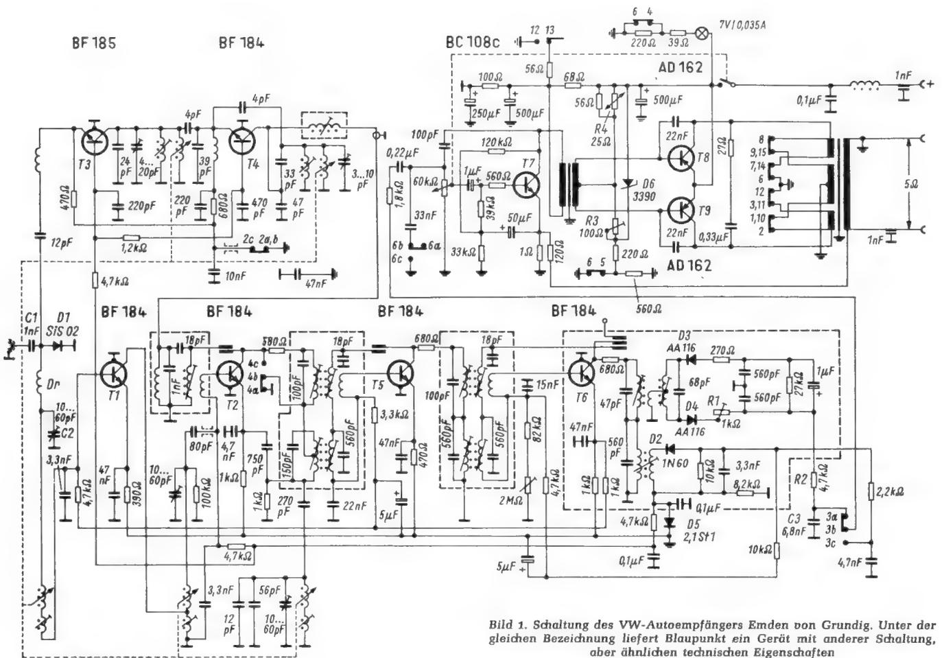
Bild 1. Schaltung des VW-Autoempfängers Emden von Grundig. Unter der gleichen Bezeichnung liefert Blaupunkt ein Gerät mit anderer Schaltung, aber ähnlichen technischen Eigenschaften
