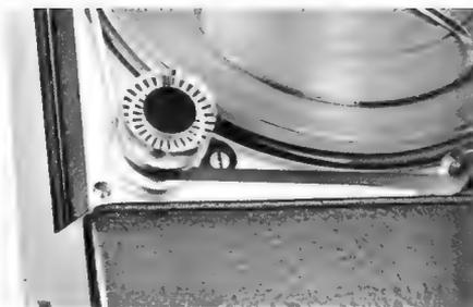
Bild 3. Rolle mit Stroboskopeilung zur Kontrolle der Bandgeschwindigkeit (innere Teilung für 60 Hz, äußere für 50 Hz)
