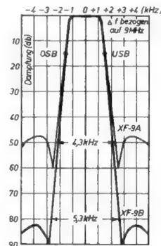
9 MHz-Quarzfilter mit vier bzw. sechs Quarzen für die Verwendung in Einseitenband-Sendern und -Empfängern.
