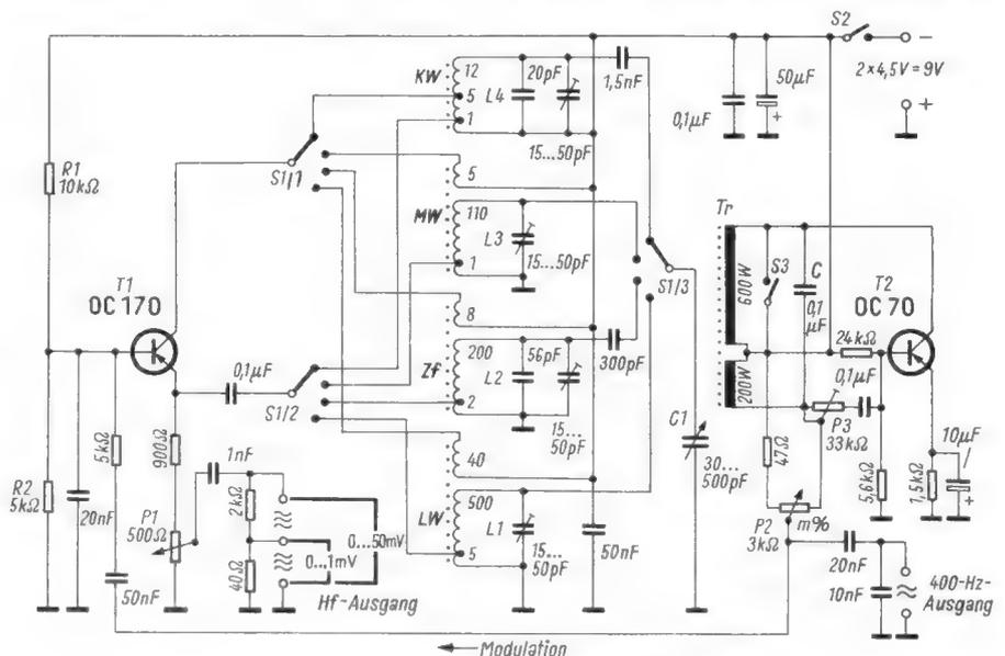
Bild 1. Schaltung des AM-Transistor-Prüfsenders
