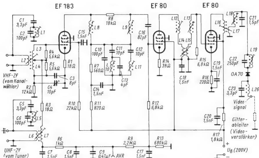
Bild 125. Gesamtschaltung eines mit Bandfilterkopplung arbeitenden Fernsehempfänger-Zwischenfrequenzverstärkers
