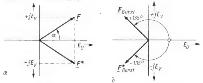
Bild 4. Modulationsanzeiger  $F$  und  $F^*$ : a) für die Bildanteile, b) für die Farbsynchronimpulse
