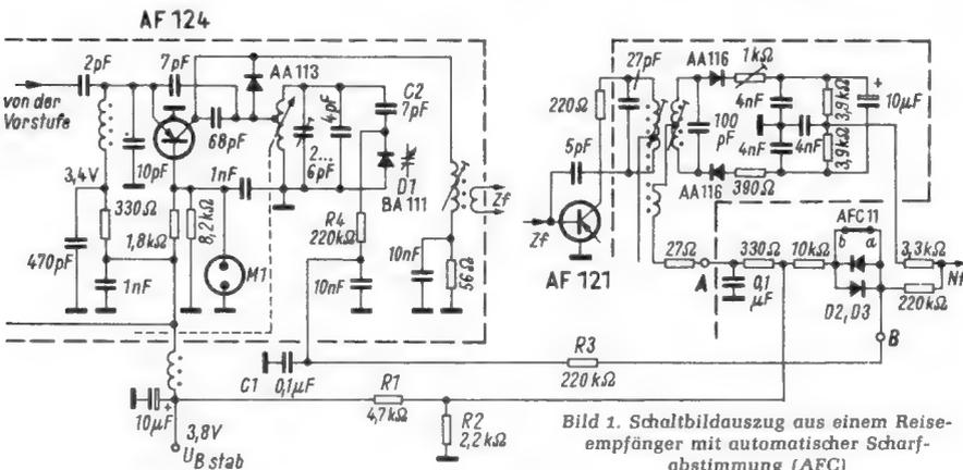
Bild 1. Schaltbildauszug aus einem Reiseempfänger mit automatischer Scharfabstimmung (AFC)
