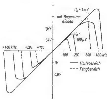
Bild 2. Nachstimmspannung in Abhängigkeit von der Verstimmung des Oszillators bei Eingangsspannungen von 100 µV und 1 mV, gemessen zwischen Punkt B und Masse in Bild 1 (Mittenfrequenz = 102 MHz)
