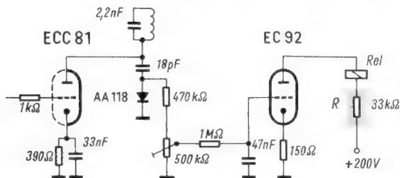
Schaltungsauszug aus einem Stereo-Rundfunkempfänger. Das Relais Rel rief einen Masseschluß auf. Dadurch blieb das Relais angezogen und schaltete auch ohne Piloton stets auf Stereoempfang
