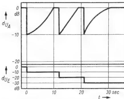
Bild 6. Verlauf der Aufsprechspannung über der Zeit mit eingeschalteter Automatik bei Pegelsprünge der Eingangsspannung von je 10 dB. Die schrittweise Herabsetzung des Eingangspegels ist in dem unteren Diagramm dargestellt
