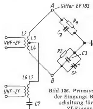
Bild 126. Prinzipschaltplan der Eingangs-Brückenschaltung für zwei Zf-Eingänge
