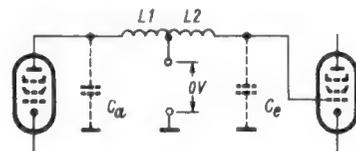
Bild 129. Ersatzschaltplan des Bifilarübertragers nach Bild 128
